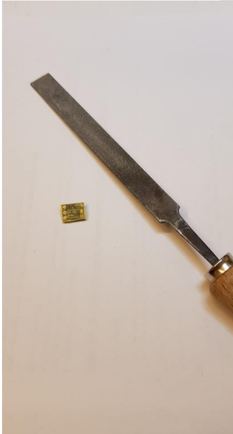
Abbildung 21 Abfeilen der Ecken am Pesky Board
