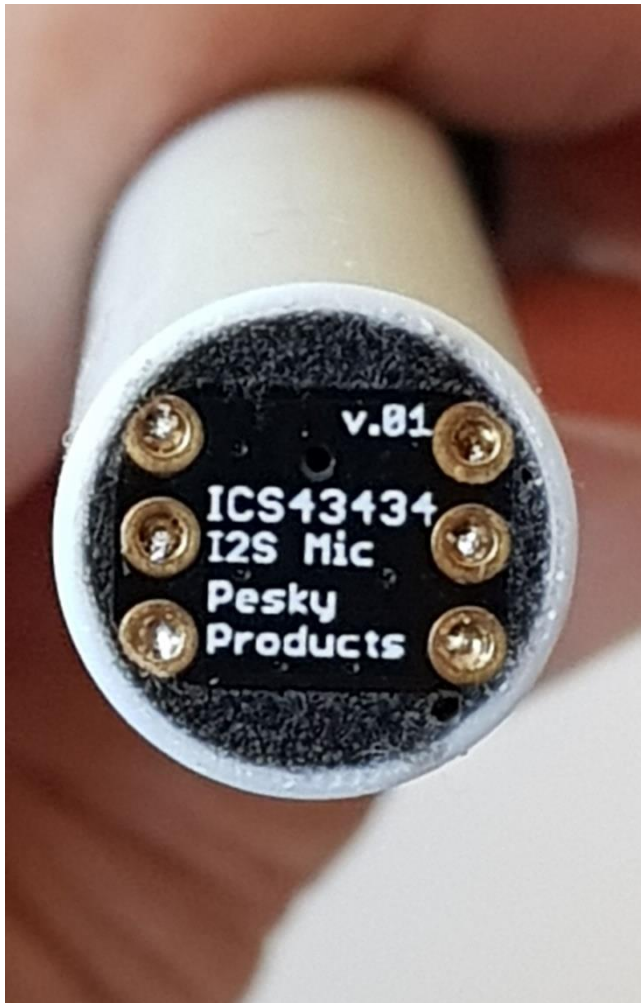
Abbildung 27 fertig ausgegossenes Mikrofonrohr
