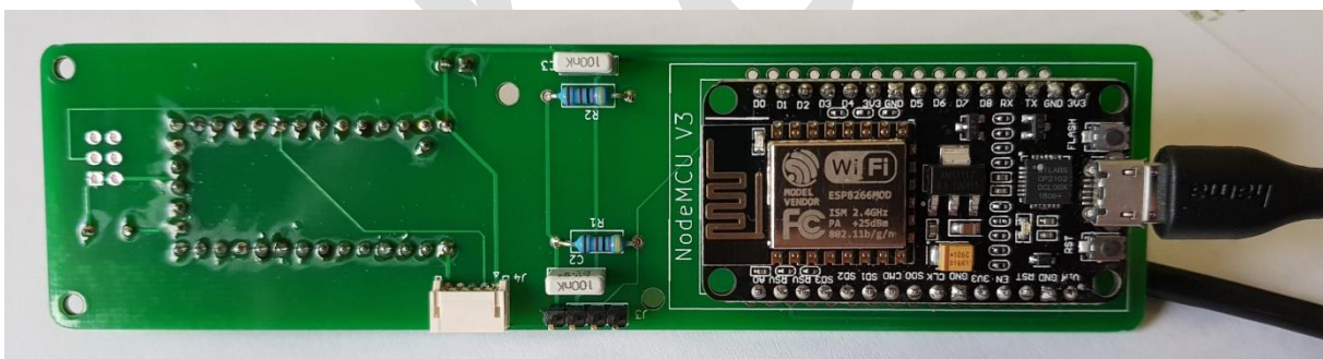
Abbildung 14 DNMS - T4+NodeMCU V1.2 Rückseite
