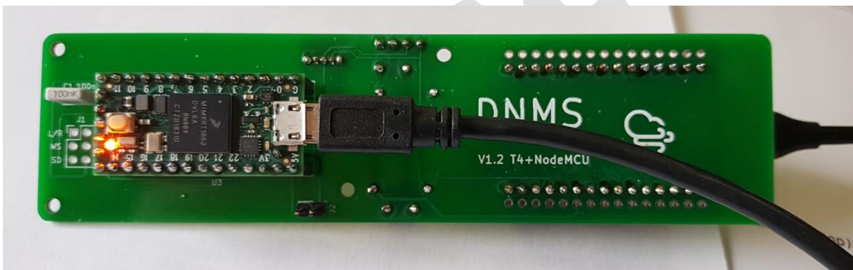
Abbildung 13 DNMS - T4+NodeMCU V1.2 PCB Frontseite
