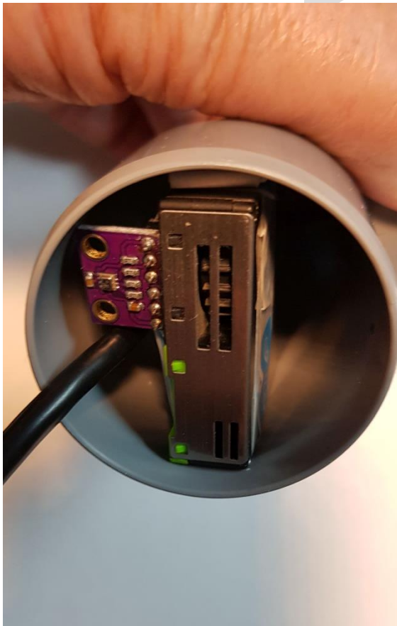
Abbildung 40 Montage SPS30 am Ende des HT DN50 Bogens
